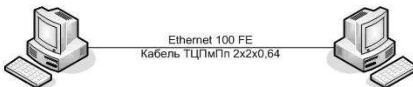
Рис.2. Схема стенда при испытании кабеля ТЦПмПп 2х2х0,64
