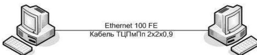
Рис.1. Схема стенда при испытании кабеля ТЦПмПп 2х2х0,9
