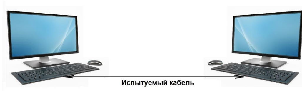
Рисунок 3 - Схема стенда для испытания кабеля без репитера
